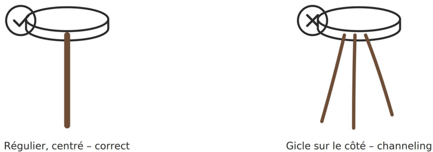
Fig. 5 : Extraction correcte (à gauche) et channeling (à droite)
